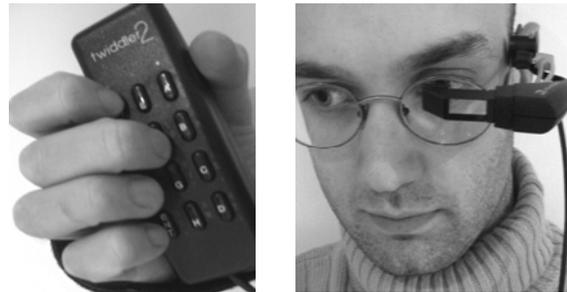
a) Clavier unidexstre à cordes (Twiddler2)      b) Affichage monoculaire opaque (Microoptical SV6)
